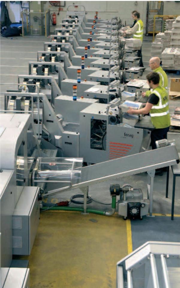
rialkosten bei der Verpackung mit PolyStream tief gehalten werden können. Bei dem Rollendurchmesser von 800 mm liegen die Produktionszeitfenster zwischen jedem Folienrollenwechsel bei rund zwei Stunden. In der nächsten Version wird die Lösung auch mit einem automatischen Rollenwechsler verfügbar sein. Wobei der manuelle Wechsel beim Kent Messenger gerade einmal drei Minuten in Anspruch nahm.
