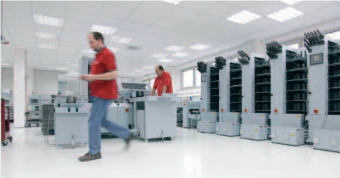
Herzstück in der Weiterverarbeitung: der Sammelhefter StitchLiner 5500 mit sechs Zusammentragtürmen vom Typ VAC-60.
