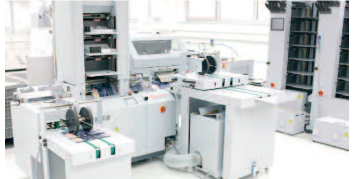
Angedockt am StitchLiner: Beilagen-Einsteckmaschine IM-30.
