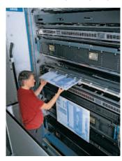
Der bewährte Plattenwechselvollautomat KBA PlateTronic ermöglicht einen extrem schnellen Auflagenwechsel für die immer mehr gefragte zielgruppen- und kostenorientierte Zeitungsproduktion.
