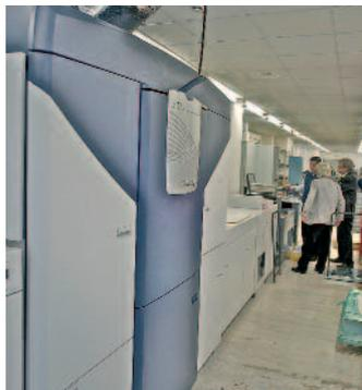
Veredelung auf einer der fünf Rotationslinien bei der Kyburz AG (ganz links) ist eine der Spezialitäten. Auch im Digitaldruck ist Kyburz zu Hause: seit Januar 2010 ist eine Xerox iGen4 im Einsatz. Im Bogenoffset hat sich die Dielsdorfer Druckerei für eine Ryobi 920 entschieden, die Offsetmaschine für das Format 640 x 920 mm. Sie ist damit für den Druck klassischer DIN-A4-Achtseiter ausgelegt.
