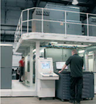
Hier hat der Digitaldruck längst industrielle Dimensionen angenommen: Inkjet-Druckköpfe von Kodak kommen bei der T-Press von Timsons zum Einsatz.
