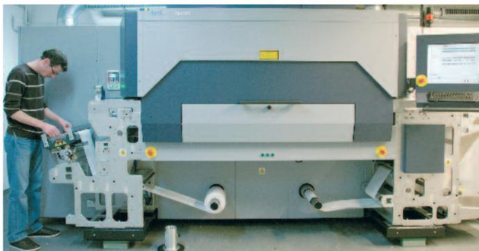
330 mm Bahnbreite und 48 m/Min. Druckgeschwindigkeit sind die wesentlichen technische Daten der Etikettendruckmaschine Tau 330 von Durst.
