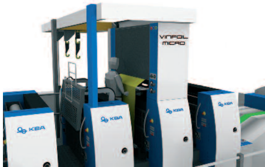
Die gesamte Einrichtung inklusive ferngesteuertem Kran ist über den Farbwerken der Rapida 106 montiert.
