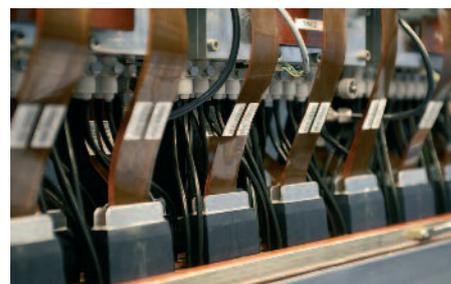
duktivität durch die überlappend angeordneten 20 Ricoh-Inkjet-Druckköpfe.
