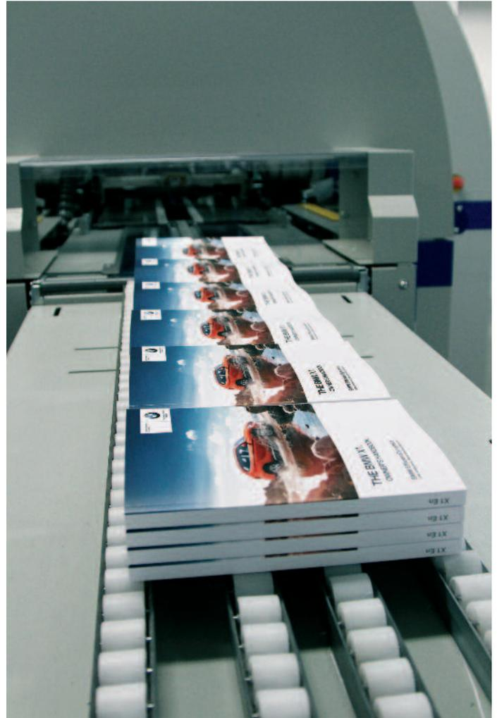
Schließlich werden Umschläge und Inhalte entweder in einem Kolbus-PUR-Klebebinder gebunden, oder mit einem Duplo-Rückstichautomaten geheftet.
