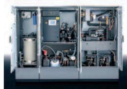
Kompressoren ausgestattet, die die Energiekosten um bis zu 50% reduzieren sollen. Die Farbwerk-Temperierkreislumpe ist mit einem elektronisch geregelten Antrieb versehen und die Kälteaggregate verfügen nach Herstellerangaben nun über einen energieeffizienten Kompressor. Durch die stufenlose Anpassung der Kälteaggregate an den Kälteleistungsbedarf der Maschine soll der Wirkungsgrad des Systems verbessert werden.
