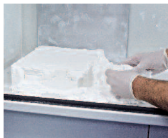
Durch die Wiederholung dieses Vorgangs entsteht somit Schicht um Schicht das gewünschte Bauteil. Nach Abschluss des Lasersinterns wird das Bauteil aus dem nicht gehärteten Pulver gelöst und durch Blasluft gereinigt.
