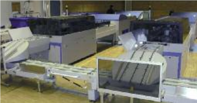
Was bei der Plattenproduktion wie hier beim ›Südkurier‹ in Konstanz (zwei Plattenlinien mit Krause-Belichtern und Entwicklungsmaschinen sowie zwei NELA VCPEvolution) längst Realität ist, wird bald auch das Bild bei
