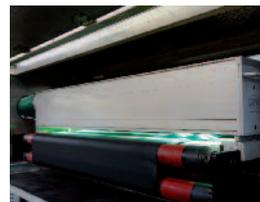
UV-Vernetzung nachgerüstet. Dazu wurden zwei 130-cm-breite Nuva2 UV-Strahler mit Rhino-Vorschaltgerät des UV-Herstellers GEW integriert. Die beiden UV-Strahler sind direkt hintereinander verbaut, um maximalen UV-Vernetzungseffekt zu erzielen. Durch den eingebauten Kühlkörper, der ohne teure Wasserkühlung auskommt, werden gleichzeitig Aufheizung des Substrats vermieden und leiser, umgebungs-luftunabhängiger Betrieb gewährleistet.
