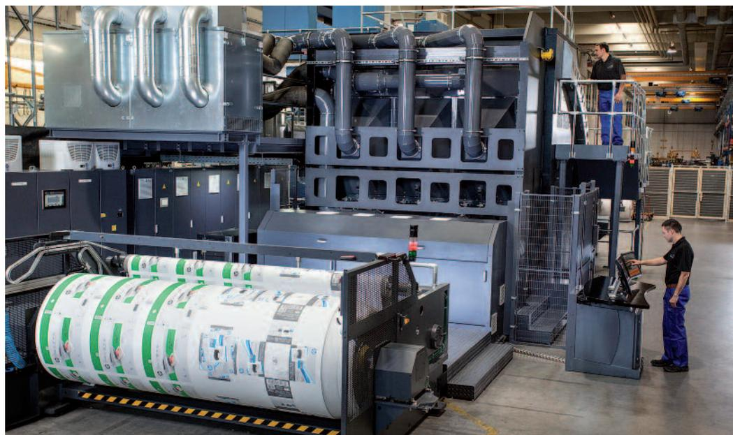
Mit 2,80 m Papierbahnbreite und einer digital bei Formaten und Auflagen flexibel bedruckbaren Fläche von über 30.000 m<sup>2</sup>/h ist die gemeinsam von HP und KBA-Digital & Web Solutions für den Wellpappen-Verpackungsmarkt entwickelte HP T1100S die grösste und leistungsstärkste Inkjet-Rotation auf dem Weltmarkt.
