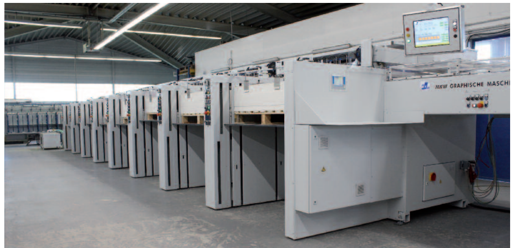
Mit acht Stationen und einer Länge von 18 Metern ist die MKW Rapid UT Gigant für Bogen bis maximal 102 x 133 cm ausgelegt und verarbeitet Substrate von 80 bis 1.000 g/m 2 .
