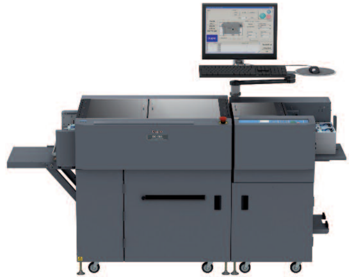
Ein typischer Vertreter der Multifinisher-Klasse: der FKS Duplo docucutter 745, der rillt, perforiert und schneidet.
