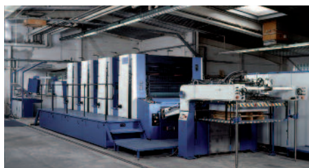
Erste MetalStar 1 bei Crown Cork 1995. Längste MetalStar 2 Konfiguration, eine 8-Farben UV Drucklinie
