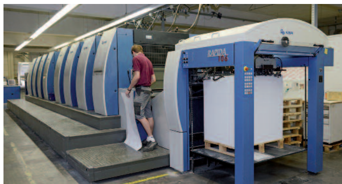
Die Rüstzeiten haben sich dank Automatisierung auch an der Achtfarben-Wendemaschine halbiert.
