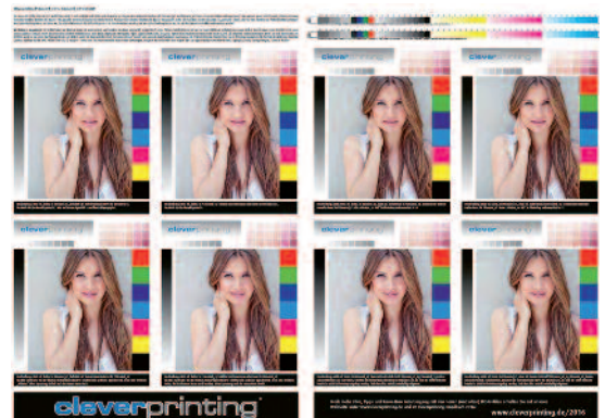
Gedruckt wurde diese Testreihe im 80er Raster, elliptischer Kettenpunkt. Papier Sappi GalerieArt silk, 150 g/m 2 , Papierweiße entspricht der neuen Norm 12647-2:2013.
