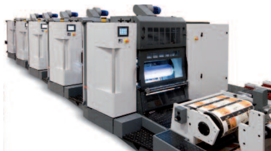
Zur drupa 2016 stellt Omet die Varyflex V2 mit den neuen Offsetdruckwerken in 850 mm Bahnbreite vor.
