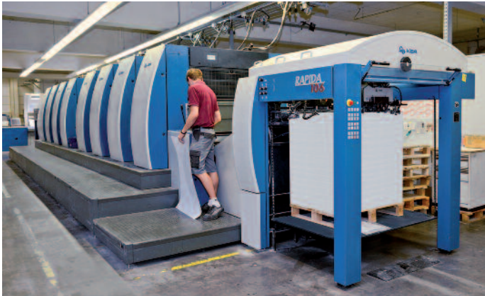
Die Rapida 106 wird als hochautomatisierte Wendemaschine im LED-UV-Druck produzieren.
