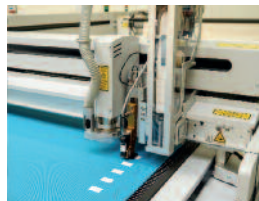
Mit dem neuen Label- und Ink Printer-Modul lassen sich geschnittene Teile direkt mit individuellen Labels bekleben und sogar bedrucken.
