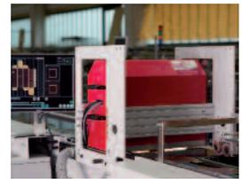
Der neue Inspektionskopf der Produktpalette EyeC Proof Runner Carton überprüft die Qualität von komplexen Faltschachteln mit Blind- und Heißfolienprägung.
