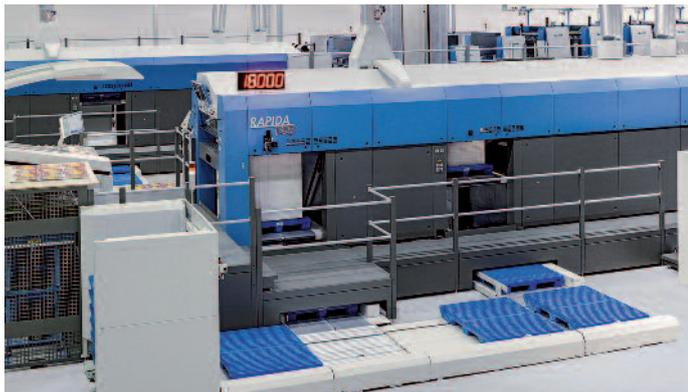
Die über 30 m lange Rapida 145 mit Doppelstapel-Auslage und automatisierter Logistik dürfte die größte Bogenoffsetanlage der drupa 2016 sein.
