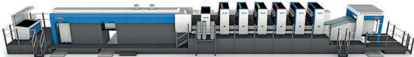
Die über 30 m lange Rapida 145 mit Doppelstapel-Auslage und automatisierter Logistik dürfte die größte Bogenoffsetanlage der drupa 2016 sein.
