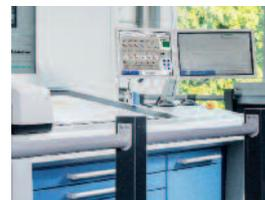
*KBA QualiTronic/ErgoTronic mit System Brunner Instrument Flight Farbregelung inklusive Farb-/Graubalance, komplette Funktionalitäten.*
