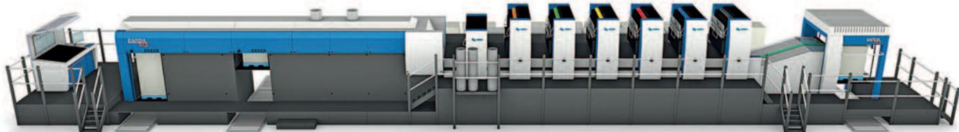
Die über 30 m lange Rapida 145 mit Doppelstapel-Auslage und automatisierter Logistik dürfte die größte Bogenoffsetanlage der drupa 2016 sein.
