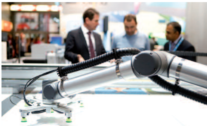
Rob, die swissQprint-Lösung für mannlosen Drucken, feierte auf der drupa Welt-premiere. Der kompakte Roboter ergänzt jeden swissQprint-Flachbettdrucker und bestückt ihn mit Bedruckstoffen.
