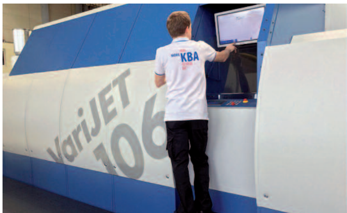
Vielversprechendes Konzept: Die KBA VariJet 106 nutzt Komponenten von KBA und eine Digitaldruckeinheit von Xerox.
