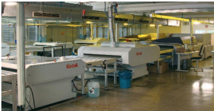
Die Bebilderung und Verarbeitung der Druckplatten auf den identisch konfigurierten CtP-Linien erfolgt weitgehend bedienerlos. Aufgrund der Stabilität des Bearbeitungsprozesses wird täglich nur eine Thermoplatte einer
