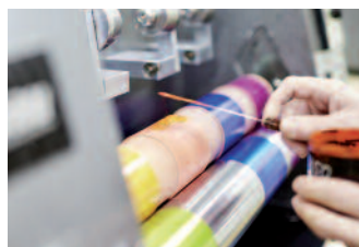
Qualitätsprüfung von Druckfarben mit einem Andruckgerät im Labor.
