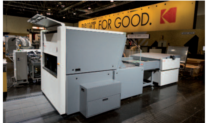
Trendsetter Q800 Plattenbelichter mit der neuen MCU (links) und Online-Plattenentwicklungsmaschine.
