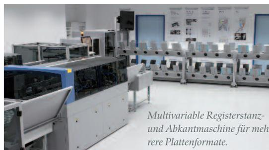
Multivariable Registerstanz- und Abkantmaschine für mehrere Plattenformate.
