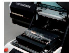
Eine verbesserte Mechanik mit einem sich während des Druckvorgangs bewegenden Drucktisch verringert Schwingungen. Außerdem werden so eine exakte Platzierung der Tintentropfen und ein qualitativ hochwertiger Druck auf einer Vielzahl von Objekten und Materialien sichergestellt.
