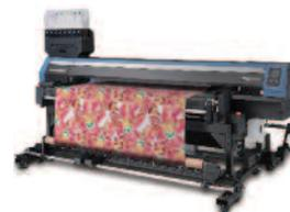
Der Textildrucker Mimaki Tx300P-1800B erreicht eine Druckgeschwindigkeit von bis zu 50 m<sup>2</sup> pro Stunde und eine Auflösung von bis zu 1.440 dpi.
