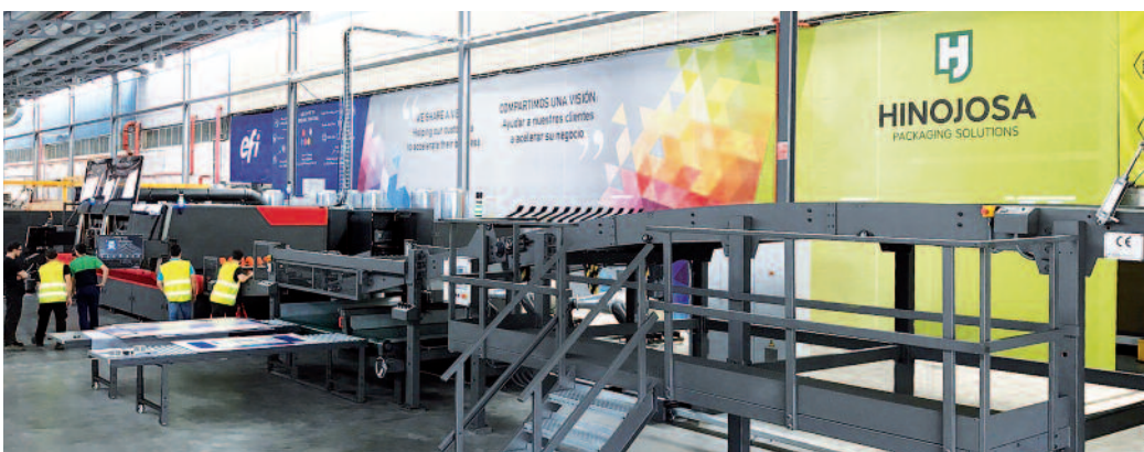
Rafael Hinojosa S.A., Entwickler und Hersteller von integrierten Verpackungslösungen aus Spanien, ist Erstanwender der EFI Nozomi C18000, eine Single-Pass-Inkjet-Druckmaschine für Wellpappenverpackungen von EFI.
