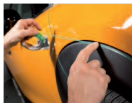
So einfach geht es: Erst mit dem 3M Knifeless Tape die Kontur kleben, dann die Folie über das Band legen und zum Schluss den Metallfaden ziehen.
