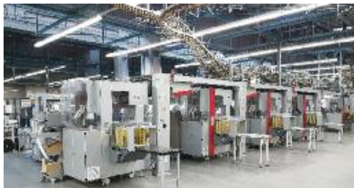
Am Ausgang der Versandraumlösung stehen MultiStack-Kreuzleger. Auch hier wurde die Kapazität erhöht.
