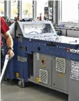
Die rotative Stanzmaschine Bograma BS Rotary 550 Servo wird bei Kromer Print offline betrieben.
