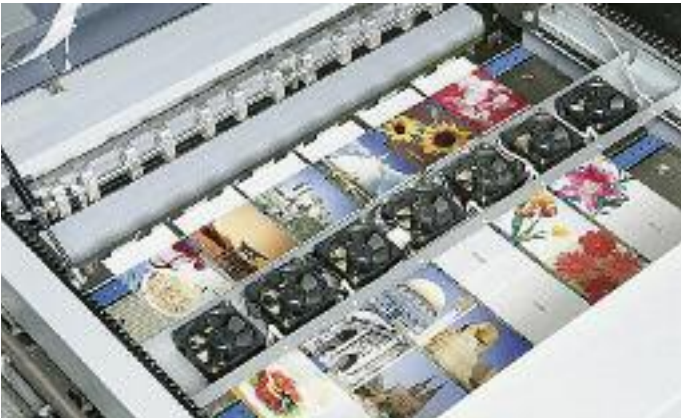
Am SmartStacker werden Ausgabeformate von B2 bis zu 100 x 105 mm in bis zu 28 einzelne Nutzen geschnitten und anschliessend in der richtigen Reihenfolge zusammen-
