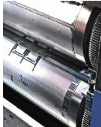
Die Stanzmaschine ist mit zwei Magnetzylindern ausgestattet, die sich in kurzer Zeit umrüsten lassen.
