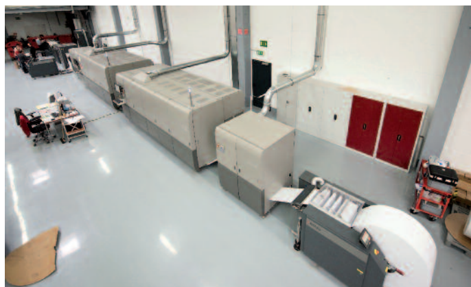
Die mit Inline-Weiterverarbeitungsaggregaten von Tecnau ausgestattete Inkjet-Rolldruckmaschine Ricoh Pro VC60000 wird von einer Tecnau u550 Abrollung mit Rollenpapier versorgt.
