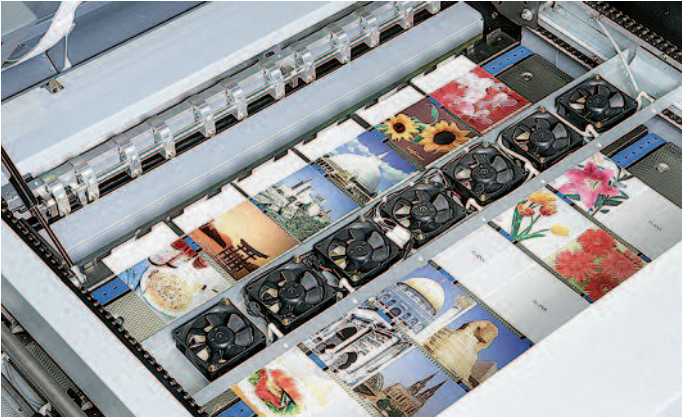
Am SmartStacker werden Ausgabeformate von B2 bis zu 100 x 105 mm in bis zu 28 einzelne Nutzen geschnitten und anschließend in der richtigen Reihenfolge zusammen-
