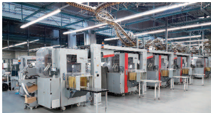
Am Ausgang der Versandraumlösung stehen MultiStack-Kreuzleger. Auch hier wurde die Kapazität erhöht.
