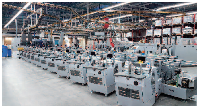
20 JetFeeder-Anleger je Linie haben bei der Chemnitzer Verlag und Druck GmbH die Einsteckkapazitäten deutlich erhöht.
