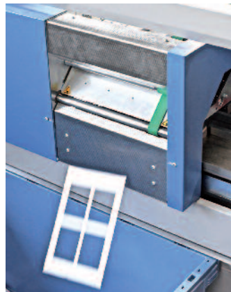
Nach dem Stanzvorgang werden die Visitenkarten ausgebrochen und die Abschnittgitter entsorgt.
