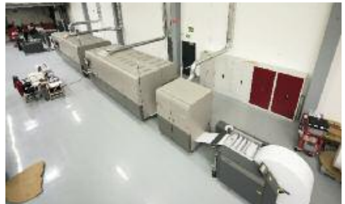
Die mit Inline-Weiterverarbeitungsaggregaten von Tecnau ausgestattete Inkjet-Rolldruckmaschine Ricoh Pro VC60000 wird von einer Tecnau u550 Abrollung mit Rollenpapier versorgt.
