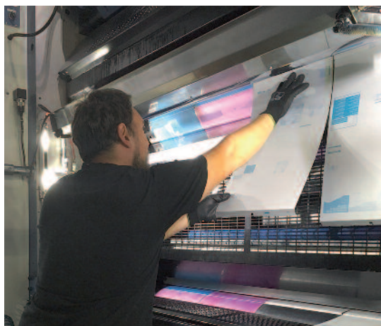
Drucker Erasmus Gläsel beim Einhängen von Libra VP Platten an einem Plattenzylinder der im Jahr 2013 in Betrieb genommenen Zeitungsrotation.
