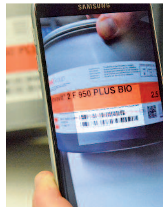
Lagerplatz mit NFC-Tag, erfassen der Farbmenge im Lager der ProductionApp und Einschannen des Chargencodes der Farbe direkt am Verbrauchsort, das heisst an dem Druckwerk, an dem es zum Einsatz kommt.
