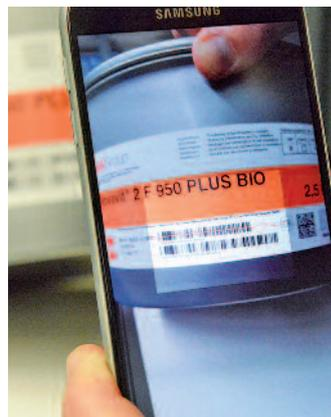
Lagerplatz mit NFC-Tag, erfassen der Farbmenge im Lager mit der ProductionApp und Einschannen des Chargencodes der Farbe direkt am Verbrauchsort, das heißt an dem Druckwerk, an dem es zum Einsatz kommt.
