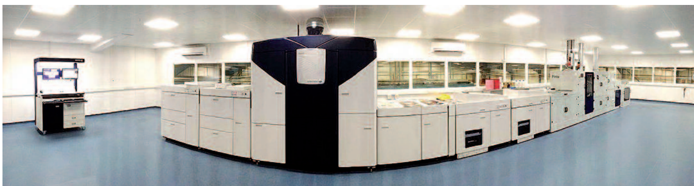
Die Inline-Anlage bei Alexir besteht aus einer Xerox iGen 4 und der Lackiereinheit von Tresu. Die Kama Stanzmaschine wird offline betrieben.
