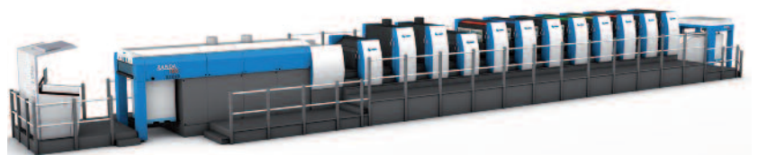
Rapida 106 mit insgesamt 12 High-Tech-Werken (8 Druck-, 2 Lack-, 2 Trockenwerke).
