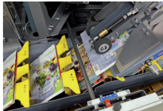
Ferag-Einstecksysteme neuester Generation ermöglichen die «garantierte Personalisierung» und die gangfolgensortierte Bildung der Pakete.
