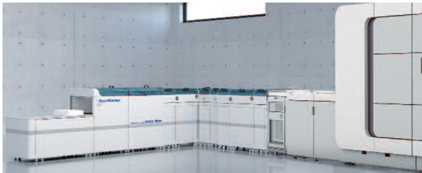
Die DocuTrim erfüllt als multifunktionales System zur Online-Bogenverarbeitung alle Anforderungen in den Bereichen Schneiden, Perforieren, Rillen und sequenzielles Stapeln.
