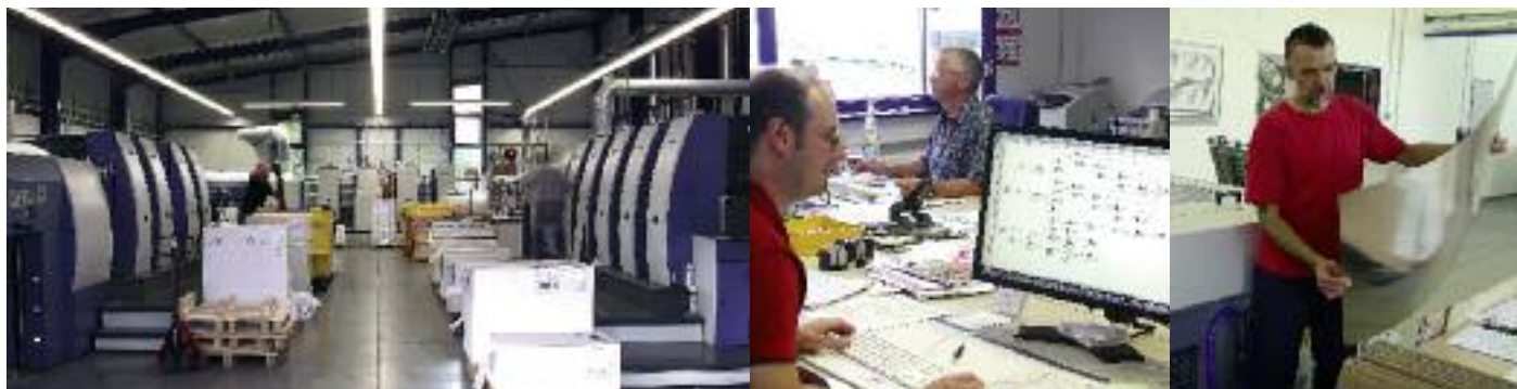
Drei KBA-Mittelformat-Bogenoffsetmaschinen in einer Hufeisenanordnung bilden das Rückgrat der Offsetdrucktechnik.
