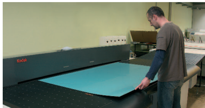
Magnus XLF 80 Quantum CtP-Systeme für die Herstellung von Platten der 80-Seiten-Rollenoffsetmaschine und andere Rotationen.
