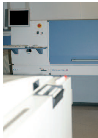
Die Druckplatten werden an einem UV-Setter von Basysprint belichtet
