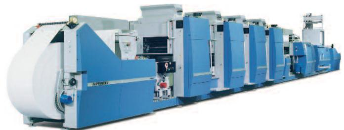
Dank StretchCorrect kann mit der Alprinta V auch bei Materialien mit stark unterschiedlicher Elastizität mit nur einem Formatsatz für verschiedenste Produkte die richtige Druckbildlänge erzielt werden.
