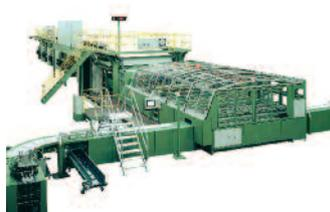
gingen im August 2009 in Produktion. Die zweite Hochleistungsanlage wird aus einem Kleinformatschneider des Typs SLK 470 von E.C.H. Will, zwei Pemco Hochgeschwindigkeitsverpackungslinien, modernster Etikettier- und Umreifungstechnologie sowie zwei W+D-Langhammer Hochgeschwindigkeitspalettierern bestehen.
