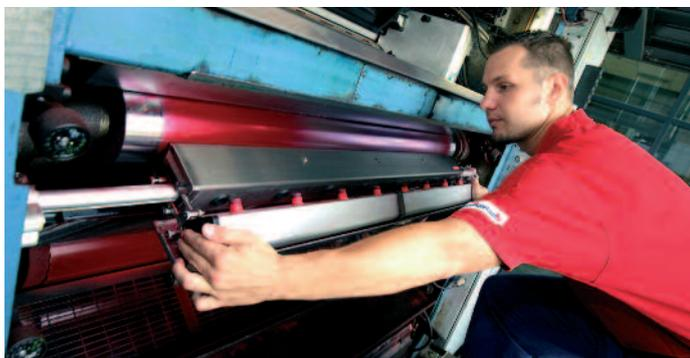
Die neuen Baldwin LithoSpray World-Sprühbalken sorgen für einen gleichmäßigeren Feuchtwasserfluss und ein optimiertes Sprühmuster, so dass auch mit einer knapperen Feuchtwasserführung produziert werden kann.
