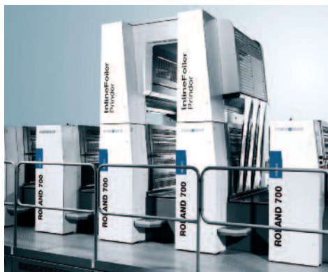
Das Kaltfolienveredelungsmodul InlineFoiler Prindor an einer Roland 700 HiPrint. Die rlc | packaging group, Hannover, veredelt hochwertige Körperpflege- und Kosmetikverpackungen mit dem Inline-Foiler.
