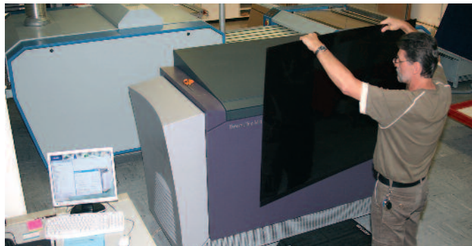
Nachdem CtP-Operator Toni Spring die in der TIFF Assembler Montagesoftware gerippten Daten zusammengestellt hat, bereitet er eine Flexoplatte für die Bebilderung auf dem Kodak ThermoFlex Mid II Plattenbelichter vor.
