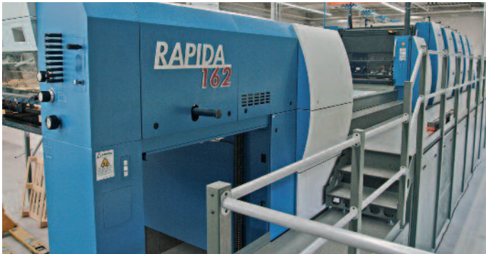
Die Rapida am neuen Standort Wustermark des Druckhaus Berlin-Mitte ist höher gesetzt und voll automatisiert.
