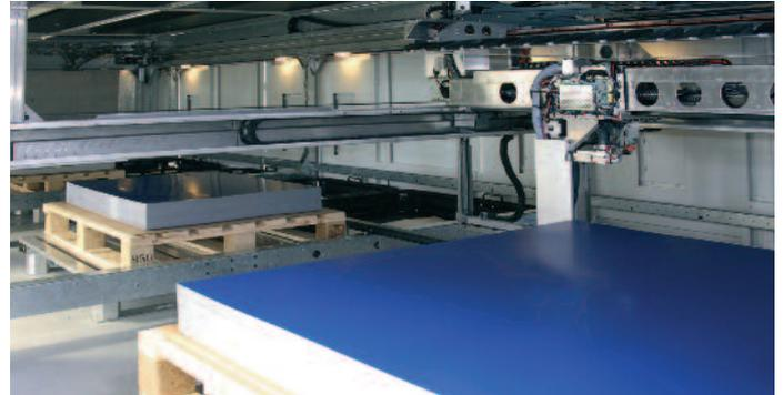
Der Palettenlader führt dem Belichter die Druckplatten direkt von den Lieferpaletten zu. Auf einer Palette befinden sich 600 (0,3 mm Stärke) beziehungsweise 300 (0,4 mm starke) Platten.
