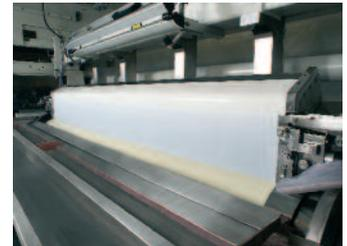
Branchenweit erstmalig nutzt Herma modernste Vorhangbeschichtungs-Technologie (Curtain Coating), um einen Dispersionshaftkleber in Kombination mit einer neuentwickelten Zwischenschicht aufzutragen.
