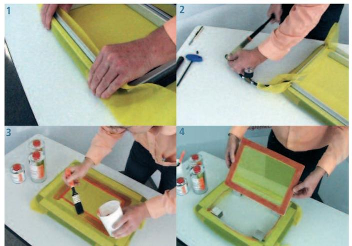
Siebspannungen bis ca. 30 N/cm sind mit wenigen Pumphüben einer gängigen Handpumpe erreichbar. Der Luftdruck dient als Referenzwert zur erzeugten Spannung. Einmal ermittelt, kann er direkt auf einem Manometer in »bar Luftdruck« abgelesen werden. Verliert das Gewebe nach einem üblichen Gebrauchszyklus an Spannung, so kann es einfach wieder gespannt werden. Eine Neuanfertigung eines Siebrahmens erübrigt sich daher.
