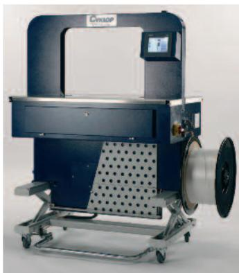
Weist innovative Details auf: Die Schmalband-Umreifungsmaschine Ampag CS von Cyklop. Dank guter Ergonomie wie dem integrierten Scheren-Hubsystem werden Bediener mit der Ampag CS schnell produktiv sein.
