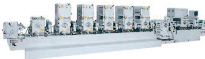
beziehungsweise 384 mm. Die kleine Maschine hat einen konventionellen Antrieb und kann mit bis zu 6 Farbwerken ausgestattet werden, die größten sind servogetrieben und können maximal 8 Farbwerke haben. Als zusätzliche Einheiten stehen neben Flexolackierwerken und Stanzwerken auch Rückseitendruckwerk und Laminiereinheit zur Verfügung. Auch Heißfolienprägung wird angeboten, flach in einer separaten Maschine als stand-alone oder in-line über Schlaufe.
