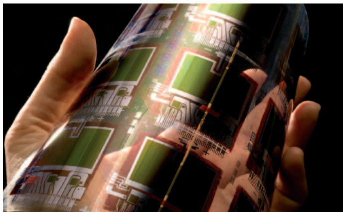
Flexibel, leicht und robust: Organische und gedruckte Elektronik ermöglicht neue Anwendungen. Beispiel einer gedruckten Solarzelle (Foto: Holst Centre, Niederlande).
