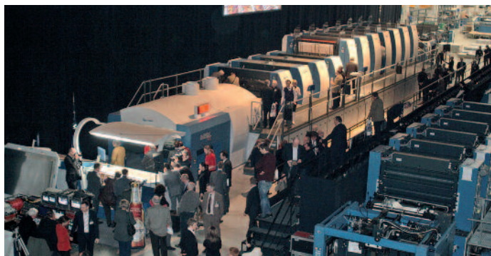
KBA zeigte eine Rapida 185 mit sieben Farbwerken, Lackturm, zwei Zwischentrocknenwerken sowie je einem weiteren Lack- und Trockenturm.
