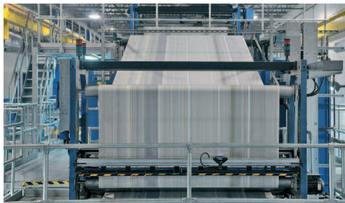
Die aktuelle Zeitungskrise in den USA ist Gegenstand vieler Veröffentlichungen und Kommentare. Dennoch installierte KBA 2009 die größte Zeitungsrotation – eine Commander CT mit 15 Drucktürmen und drei Falzwerken – bei der New York Daily News (Foto: Newspapers & Technology).
