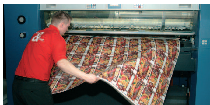
Ausstoß pro Stunde im Formatvergleich. Trotz geringerer Geschwindigkeit punkten die Großformate. 25 Nutzen einer Müsliverpackung auf einem Bogen im XXLplus-Format. Kernthema ist jedoch nicht die Fortdruckleistung, sondern das Reduzieren der Rüstzeiten und der Anlaufmakulatur.
