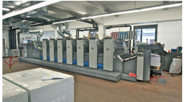
Mit der Ryobi 920 setzt man auf Effizienz: etwa 37% weniger Strom, 27% weniger Plattenfläche, 30% weniger Platz und 10% weniger Makulatur.
