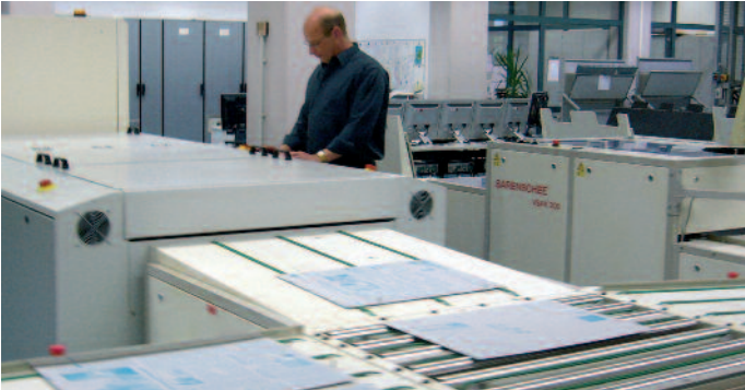
Michael Voigt, Abteilungsleiter Druckformherstellung bei der Leipziger Verlags- und Druckereigesellschaft, an einer Verarbeitungsanlage, in der die Druckplatten mit dem Kodak 206 Plattentwickler entwickelt werden.
