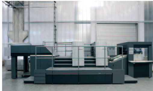
Die Speedmaster XL 105-DD arbeitet nach dem Prinzip der Rotationsstanze und wurde speziell für die Verarbeitung von Inmould-Etiketten entwickelt.
