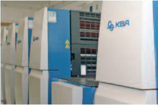
Die Bogenwendung nach dem zweiten Druckwerk und der Lackturm am Ende machen die Rapida 75E-Fünffarbenmaschine bei Hoffmann-Druck zu einem flexiblen Produktionsmittel.
