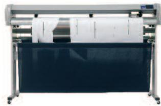
1400 (Schneidebreite 1.365 mm) und Kona Apparel 1650 (Schneidebreite 1.615 mm). Dieser neue Plotter ermöglicht das Plotten in langen Längen von Markierung auf Designvorlagen und das Schneiden von Schnittmustern.
