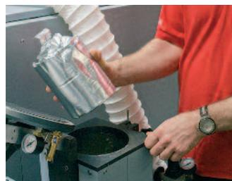
Das Bindegut wird manuell in die Zange eingegeben (Abbildung oben) und über Fräse, Leimwerk, Anpressstation und Abkühlstrecke in die Auslage transportiert. Die 2-Kilo-PUR-Kerze wird in die Tankschmelze eingegeben, aufgeschmolzen und zur Düse transportiert.
