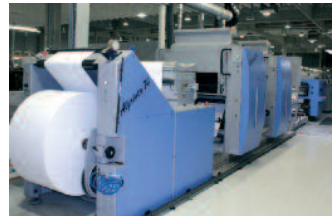
Alprinta 74 mit neuentwickelter Bogenauslage – August Faller verfügt in Binzen über eine der europaweit modernsten Rollenoffset-Druckmaschinen für Pharma-Packaging.
