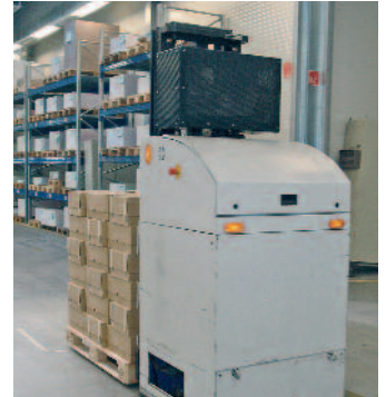
Fahrerlose Transportsysteme sorgen für einen lückenlosen Materialfluss.
